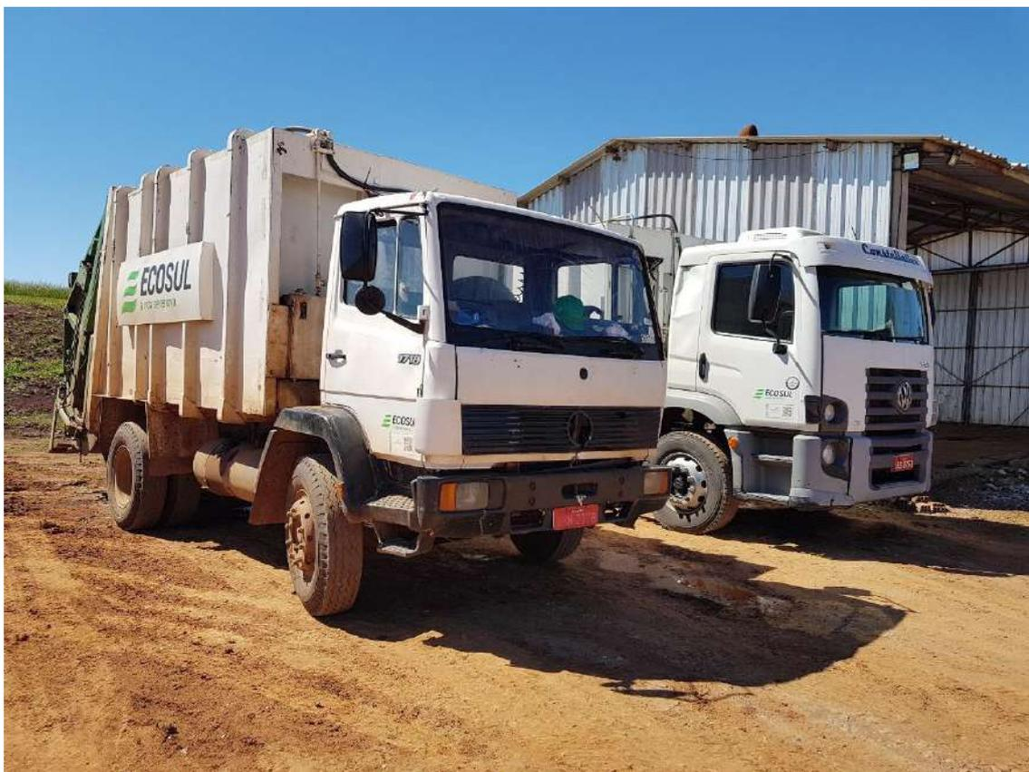
*Figura 91: Caminhão coletor equipado com compactador (12m<sup>3</sup>)*
