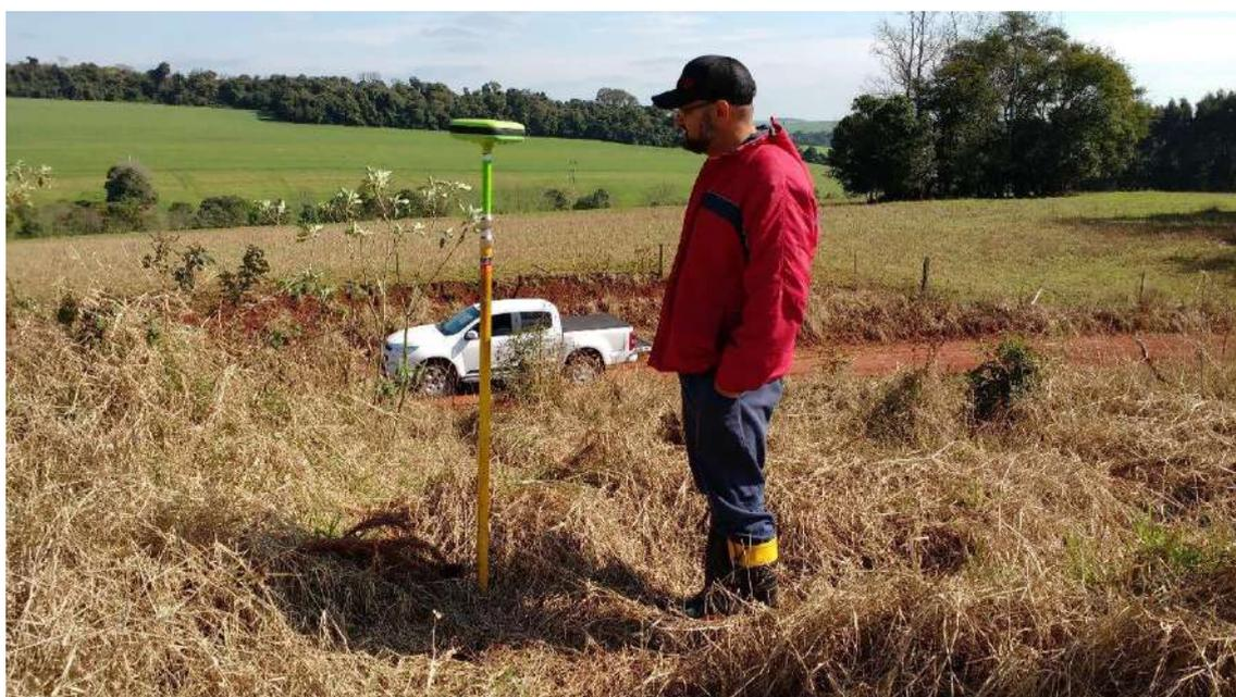
*Figura 108 – Base móvel para leitura de pontos na área.*
