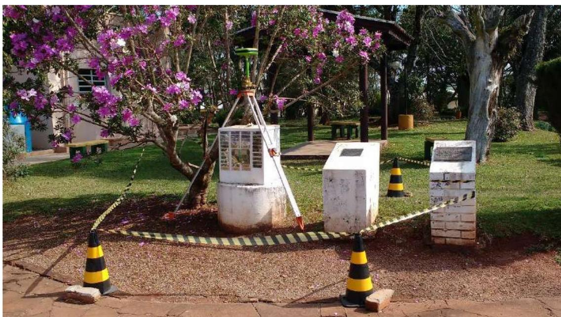
*Figura 107 – Ponto Base – Aparelho RTK em funcionamento*
